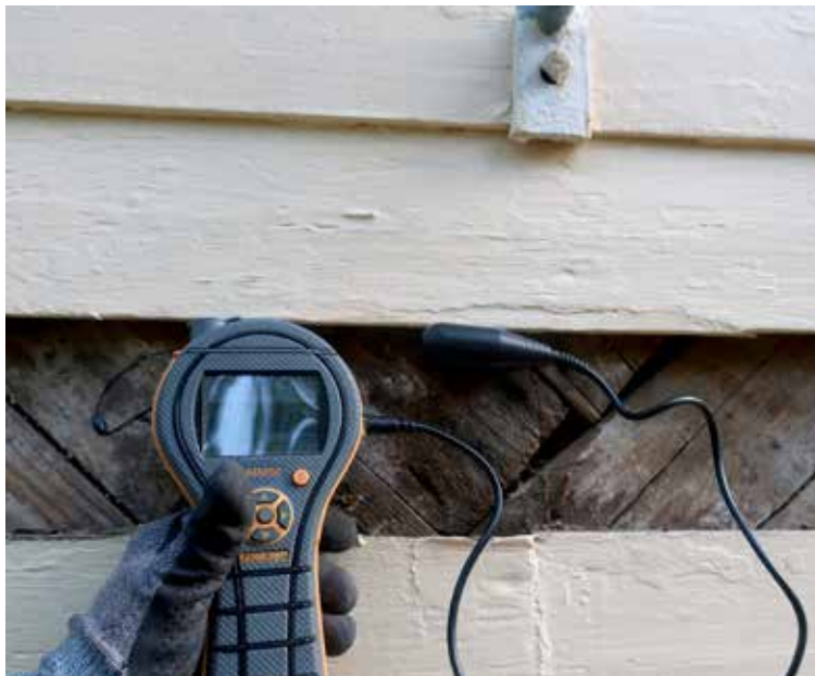
Rintamamiestalon seinärakenteeseen on syntynyt lahovaurioita kattotikkaiden kiinnityspulttien alapuolelle.
